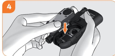
4 Insérez la nouvelle cassette-test dans le lecteur. Refermez le couvercle du compartiment de la cassette et le capot de protection.
